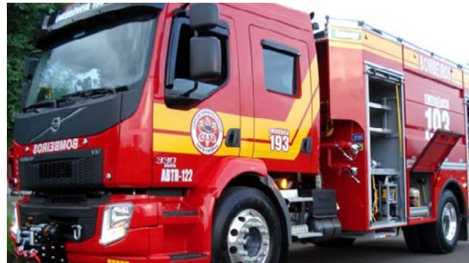
Figura 16 - Viatura com bombas de incêndio acopla-
