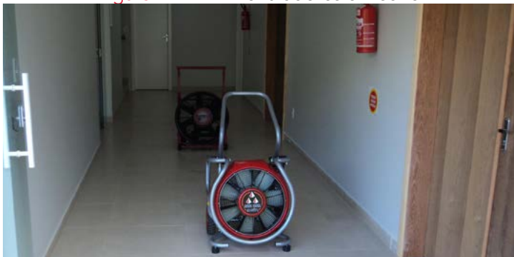
Figura 12 - Ventiladores em série
