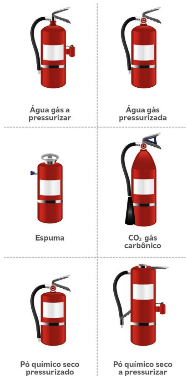
Figura 4 - Classificação dos extintores
